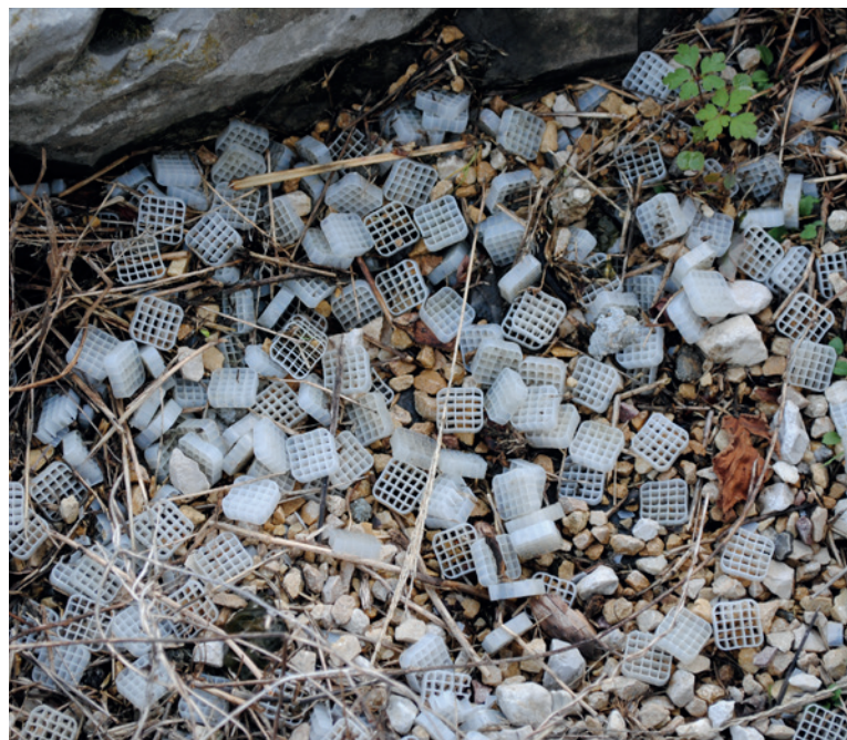
Ci-dessus : Biomédias issus de la STEP de Saint Prex (Suisse) et échoués sur les berges du lac Léman © Frank Odenthal
