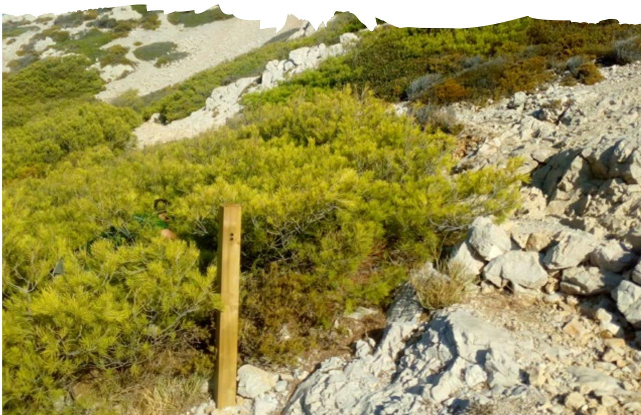
*Éco-compteur PYRO camouflé dans un poteau en bois, à l'entrée d'une sente fermée par des blocs rocheux, secteur de Callelongue-Marseilleveyre*
