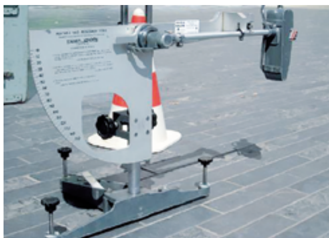
Outil de mesure de l'adhérence d'un revêtement (type pendule SRT via la norme XP CEN/TS 16165 : source : CRR)
