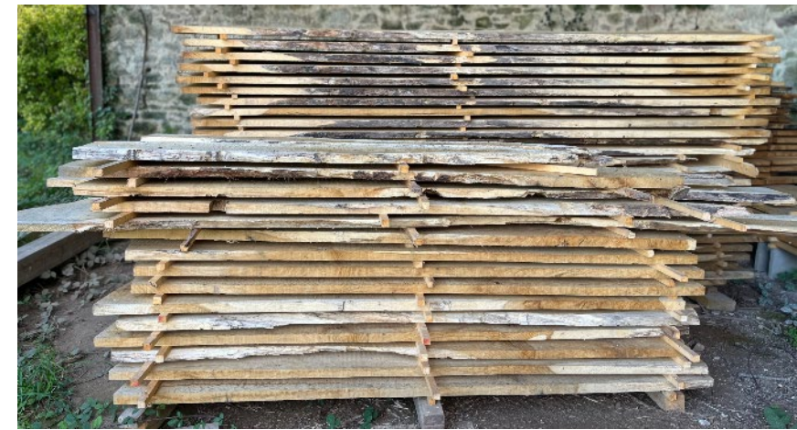
Futur plancher bois récupéré et scié sur site
