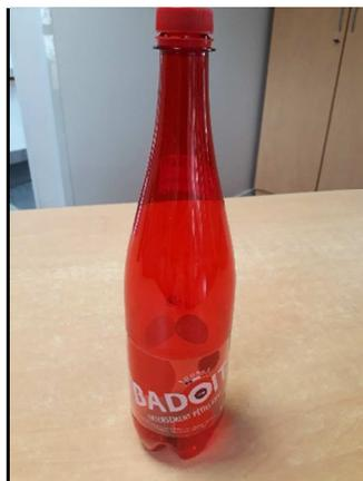
L'entièreté du contenu de la bouteille (1 L) a été filtré et les particules analysées par IRTF. Le bouchon est constitué de polyéthylène et le corps de la bouteille de polyéthylène téréphtalate. Les résultats sont présentés dans le tableau ci-dessous :
