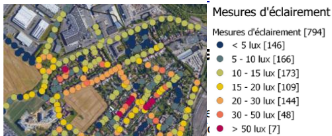
Niveaux d'éclairage mesurés
