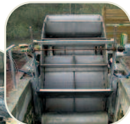
Aqualienne Tests à faire 1 à 3 m de chute
