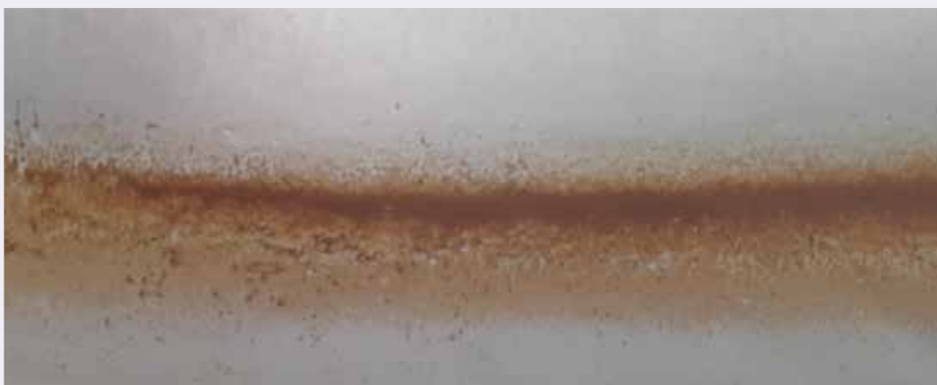
Exemple de bande de gras sur cuve de cuisson après cuisson de rôtis en bac inox • Nice
