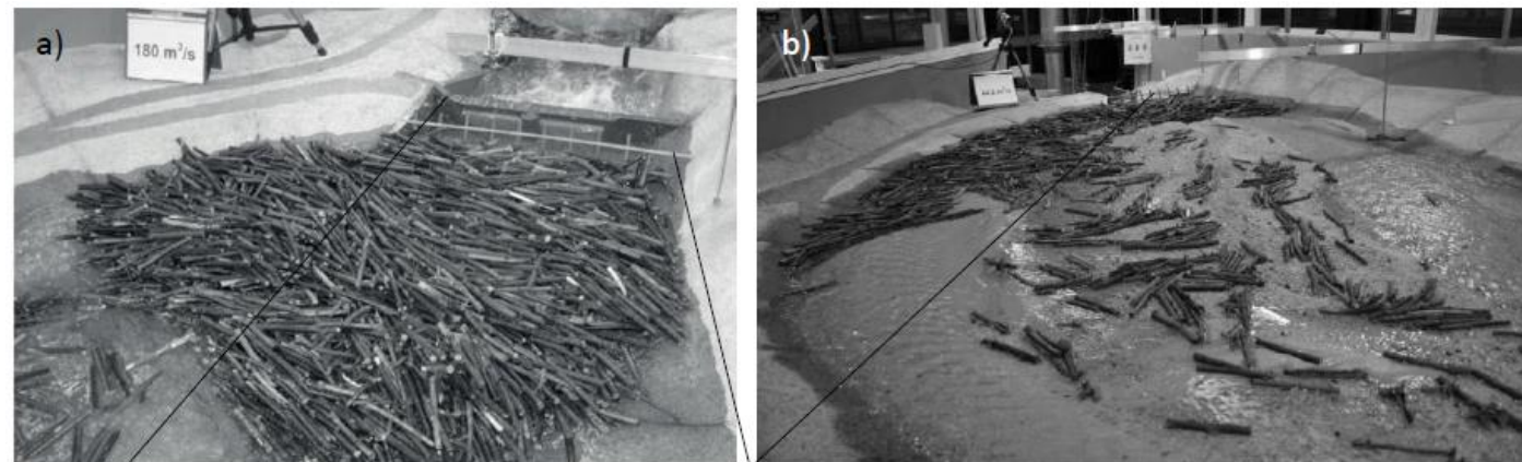
a) Barrage à double pertuis 2 \times 0,75 \times 5,0 \text{ (NxHxB)}
