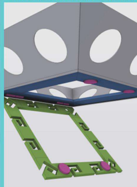
SYSTEME DE CROCHETAGE DU FILET RAPIDE PAS DE RISQUE DE REFOULEMENT
